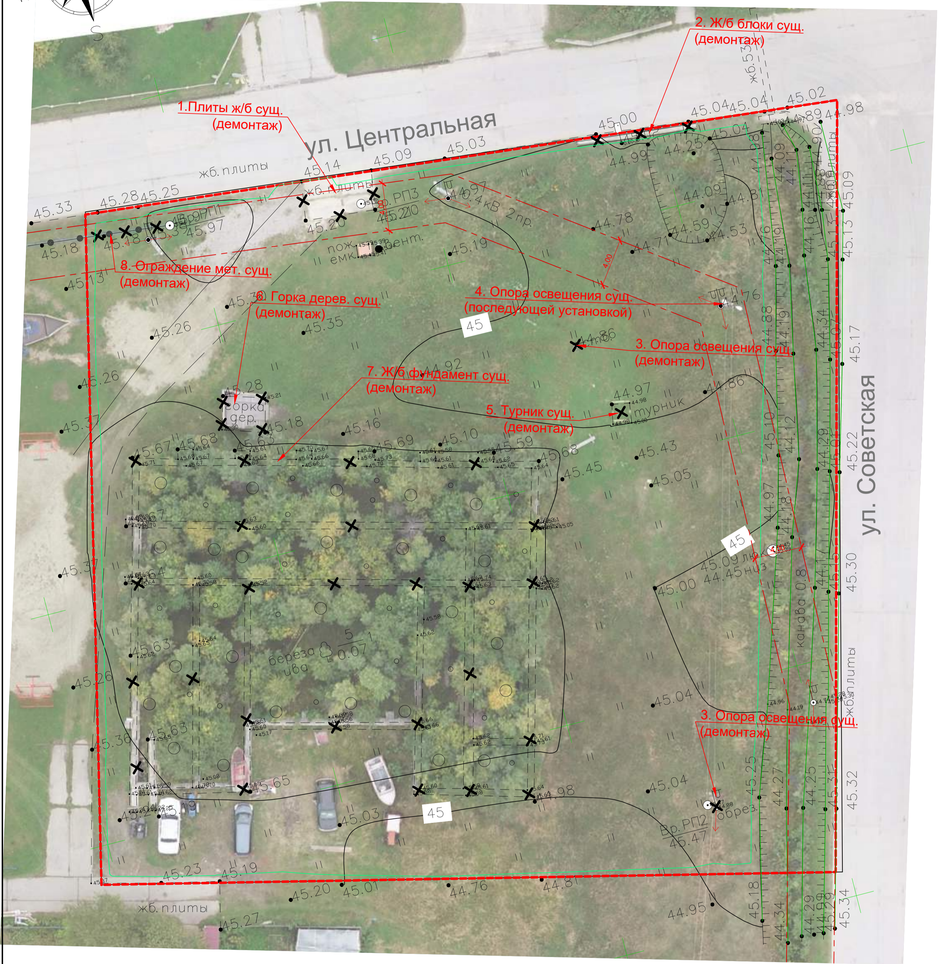
Ведомость демонтируемых элементов
