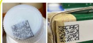
Смещение кода маркировки при печати
