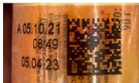
Печать кода маркировки на бликующей/светлоотражающей поверхности
