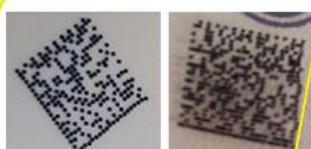
Нарушение геометрии кода маркировки (модуляция)
