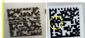
Смазывание кода маркировки или его отдельных элементов
