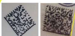
Нарушение геометрии кода маркировки (модуляция)
