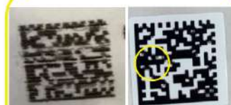
Смазывание кода маркировки или его отдельных элементов
