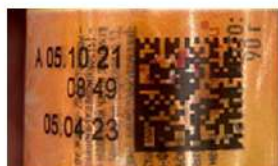
Печать кода маркировки на бликующей/светлоотражающей поверхности
